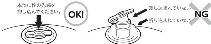
※空気栓は、栓と弁の二重構造になっていますが、弁は空気の急激な漏れを防ぐ補助弁であり、空気を完全に止めるものではありません。
