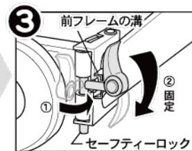
図のようにクイックレバーを回転させて前フレームの溝にひっかけます。クイックレバーを下向きに締めて確実に固定して下さい。
