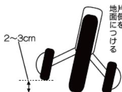
補助輪は、片側の補助輪を地面につけた時に、もう一方が地面から2~3センチ浮いているのが正常な取り付け位置です。
