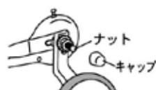
キャップをはずし、ナットをゆるめてください。補助輪が上下にスライドして高さを調整できるようになります。調整後はナットを締めて補助輪にガタ付きがない事を確認しキャップを締めてください。
