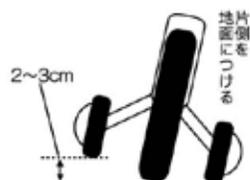
補助輪は、片側の補助輪を地面につけた時に、もう一方が地面から2~3センチ浮いているのが正常な取り付け位置です。地面についている場合や、左右の高さが異なっている場合は調整してください。
