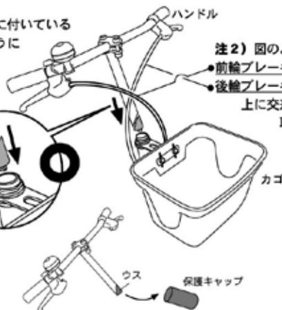
注2) 図のように、前輪ブレーキワイヤが後輪ブレーキワイヤの上で交差するように取り付けます。
