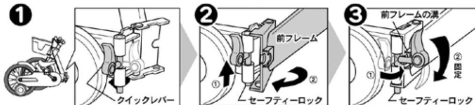
折りたたみ部のクイックレバーを外側に回します。
