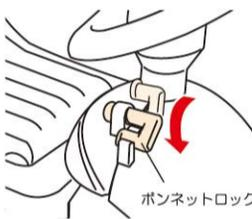
前ボンネットに付いているボンネットロックを図のようにカチッとハマる所まで倒してボンネットの前後を固定します。
